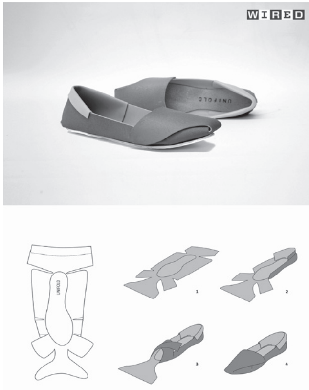
Figs. 4 y 5. Horatio Yuxin Han and Kevin Crowley. Unifold , 2012. Zapato plegable, modelo alpargata. Patrón y proceso de montaje. Imágenes: Cortesía del autor.
